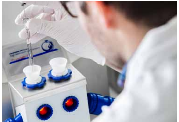
Wissenschaftler der Arbeitsgruppe Physiologie des Energiestoffwechsels injiziert einen Substratmix in die Kammer eines Respirometers. Scientist of the Research Group Physiology of Energy Metabolism injects a substrate mix into the chamber of a respirometer.
