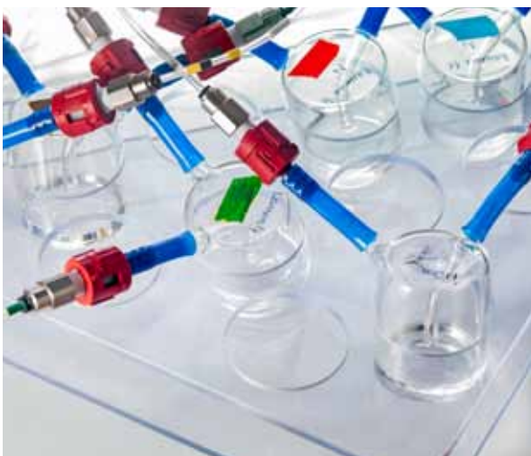
Verschiedene Duftgefäße eines Olfaktometers Receptacles with various odorants for olfactometer analysis
