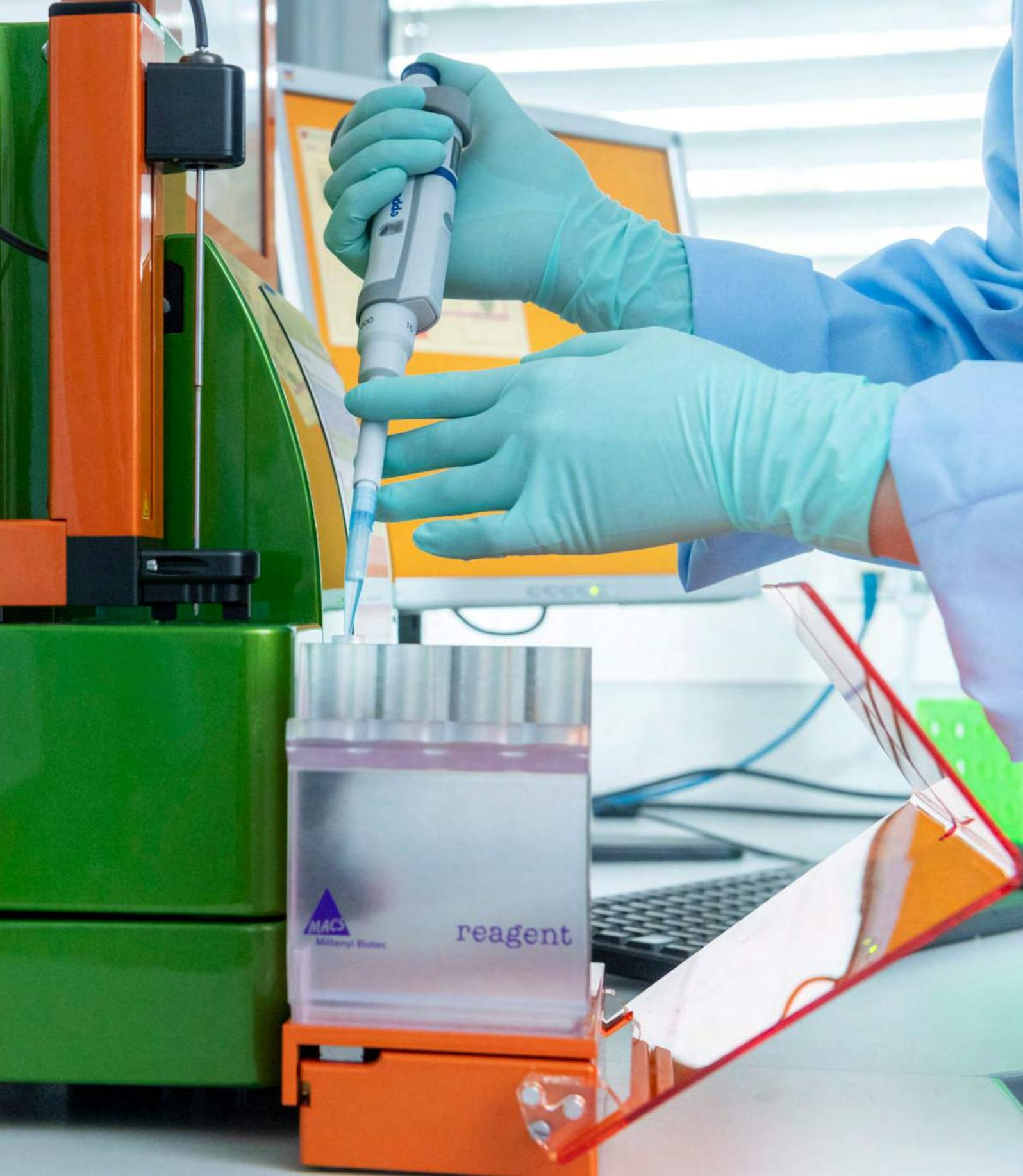
↑ *Mit einem Durchflusszytometer werden Einzelzellen über einen Flüssigkeitsstrom voneinander getrennt an einem Laser vorbeigeführt. Durch die vorherige Markierung mit fluoreszierenden Farbstoffen können gleichzeitig zahlreiche Parameter gemessen werden, die z. B. Auskunft über oxidativen Stress oder Veränderungen im Zellzyklus geben.*
